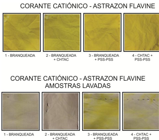
Figura 14 - Amostras tingidas com corante fluorescente catiónico Astrazon Flavine 10 GFF e amostras lavadas à luz diurna
