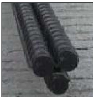
a) Varões de CFRP
