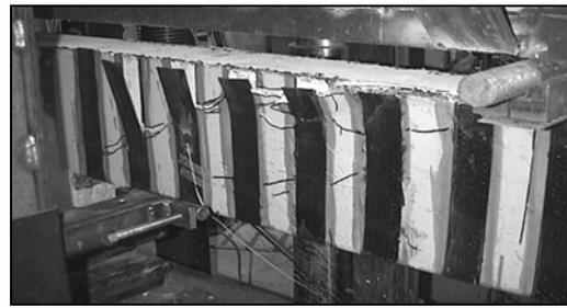
a) Colagem externa de mantas de CFRP (Khalifa, 1999)
