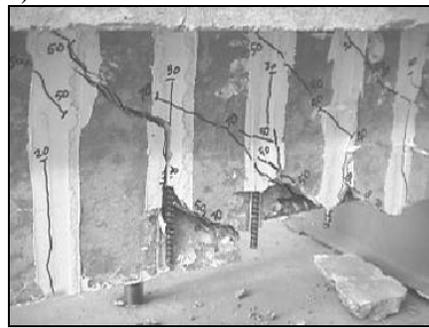
c) Inserção de varões de CFRP em entalhes efectuados no betão de recobrimento (De Lorenzis *et al.*, 2001)
