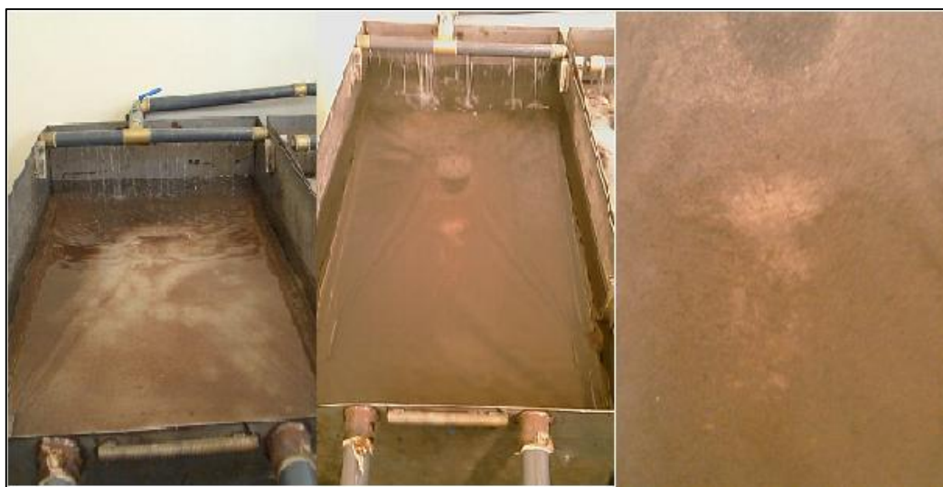
Figura 4.6 - Camada superficial de finos e biofilme (Schmutzdecke), fases de formação.
