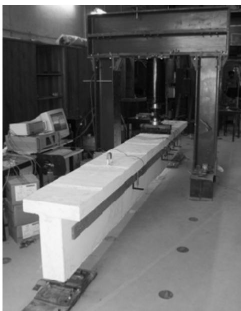
Figura 3.11 - Esquema geral do ensaio monotónico à rotura.
