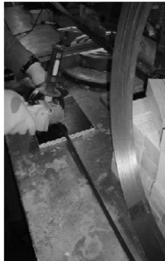
b) Corte dos laminados
