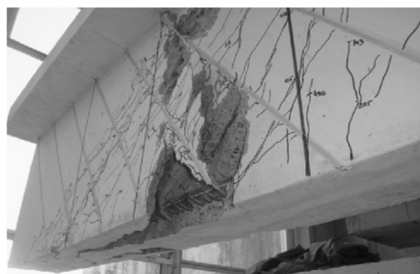
Figura 3.26 - Pormenores do modo de rotura da viga 3S-9LI-M.
