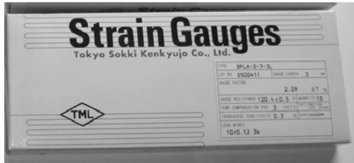
Figura 3.14 - Extensómetros elétricos utilizados na instrumentação dos laminados.
