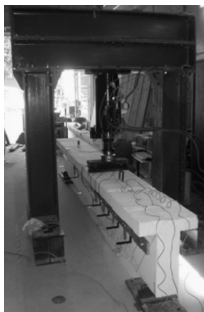
Figura 3.11 - Esquema geral do ensaio monotónico à rotura.
