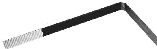
Figura 2.29 - Laminados pré-fabricados de CFRP em forma de L concebidos para o reforço ao corte de vigas de betão armado (Sika® CarboShear L®, 2003).
