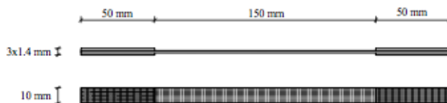
b) Dimensões do provete
