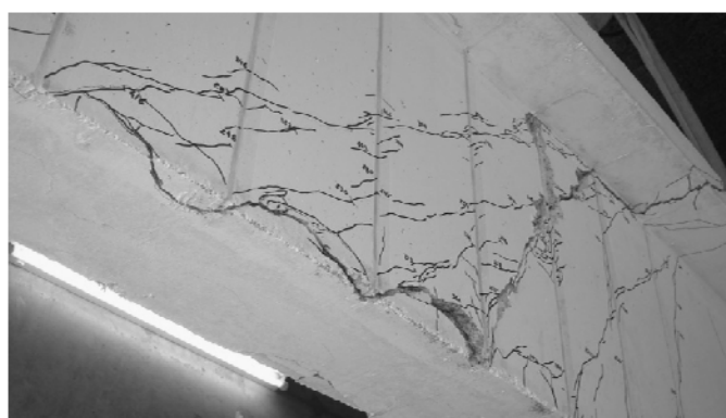
c) Cedência do quarto laminado a contar da secção de aplicação da carga
