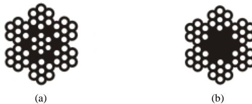
Figura 52 – Representação da secção dos cabos de aço inoxidável: (a) cabos com 2 e 4 milímetros de diâmetro; (b) cabos com 6 milímetros de diâmetro
