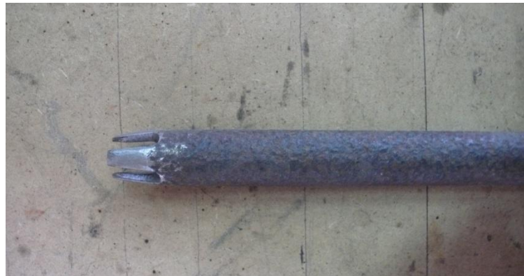
Figura 55 – Peça que facilita a inserção das heli-agulhas nas juntas de argamassa
