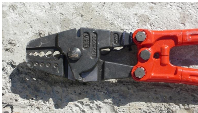
Figura 71 – Alicate apropriado para garantir o confinamento necessário ao bom funcionamento dos estropos
