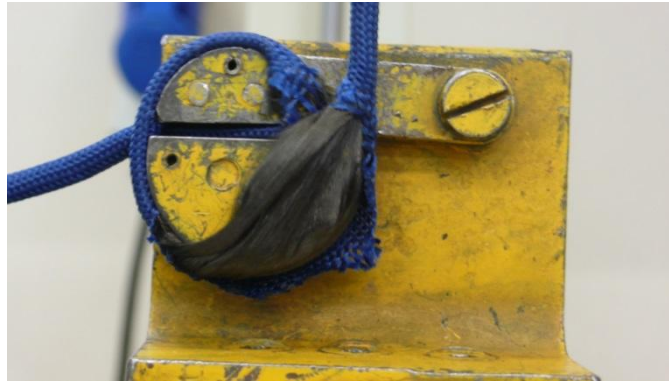
Figura 82 – Rotura de um dos cordões reforçados com fibras de carbono quando ensaiado à tração
