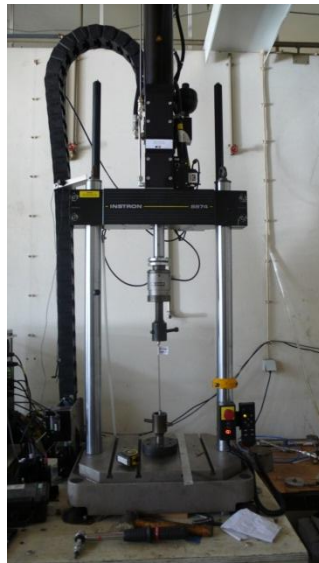
Figura 72 – Máquina de tração utilizada para ensaiar os cabos de aço inoxidável
