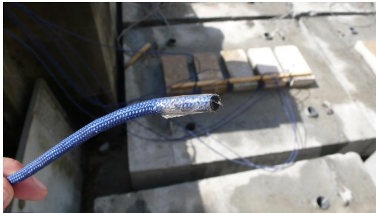
Figura 53 – Cordão sintético reforçado com fibras de carbono com 4 mm de diâmetro
