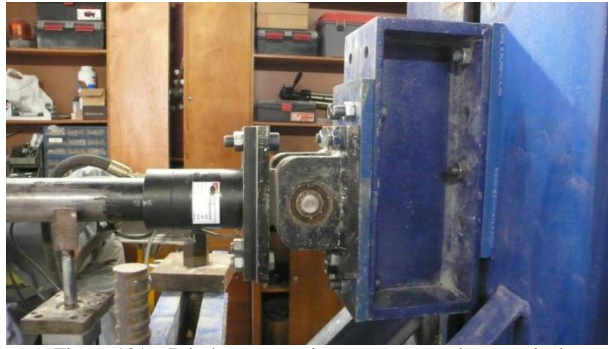
Figura 101 – Rótula que permite a rotação no plano vertical
