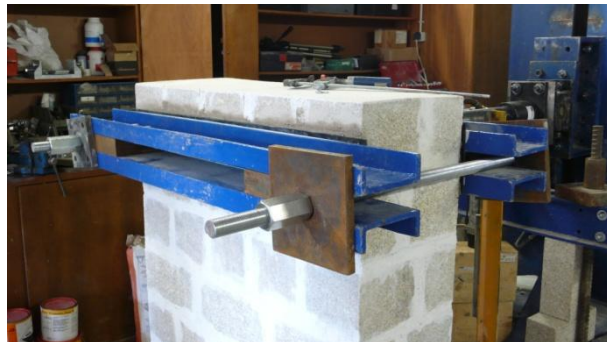
Figura 99 – Vigas gémeas de distribuição da força apertadas nas extremidades
