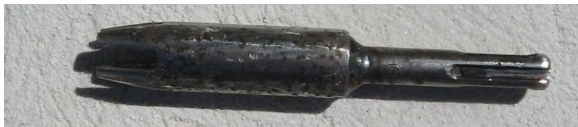
Figura 57 – Estado final da peça criada para facilitar a inserção das heli-agulhas
