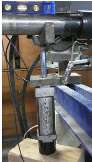
Figura 102 – Suporte pneumático do atuador
