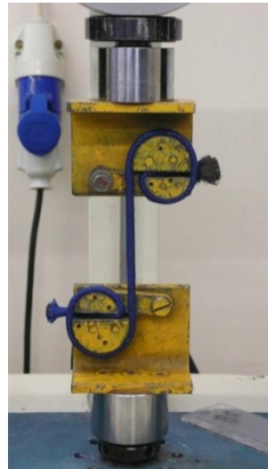
Figura 78 – Ensaio de tração a um cordão reforçado com fibras de carbono
