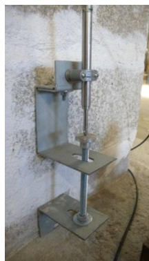
Figura 103 – Transdutor LVDT situado na base com o objetivo de medir o deslocamento vertical
