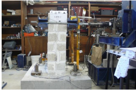
Figura 108 – Parede URW.2 imediatamente antes de se dar início ao ensaio de flexão
