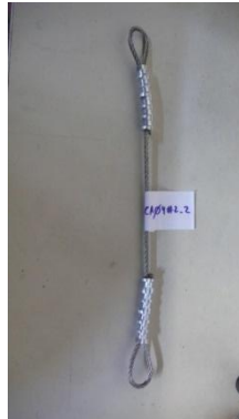
Figura 77 – Provete de aço inoxidável com 4 mm de diâmetro e 2 estropos em cada extremidade
