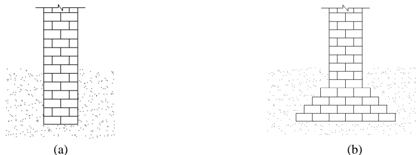
Figura 1 – Fundações: a) fundação direta resultante do prolongamento das paredes; b) fundação direta com um aumento de espessura da parede (Pires, 2009)
