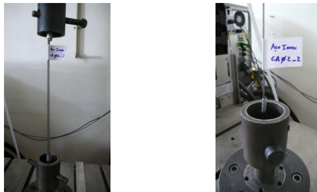
Figura 73 - Fotografias dos ensaios de tração dos cabos de aço inoxidável
