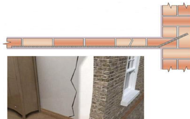
Figura 39 - Reparação de ligações entre paredes interiores e exteriores utilizando armadura helifix
