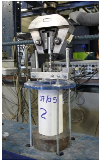
(a) Figura 84 – Ensaio de arrancamento: (a) setup do ensaio; (b) pormenor da amarra utilizada
