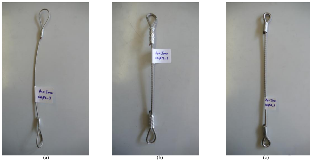
Figura 68 - Provette de um cabo de aço inoxidável 6X7-CWS Inox Aisi 316 prontos a serem ensaiados à tração: (a) cabo com 2 mm de diâmetro; (b) cabo com 4 mm de diâmetro; (c) cabo com 6,4 mm de diâmetro
