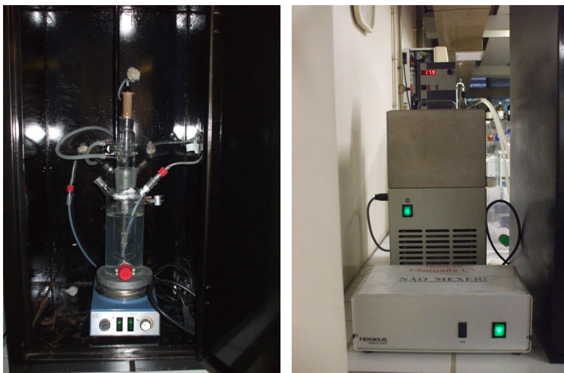
Figura 8 - Ilustração das componentes do sistema do reator UV, do sistema de refrigeração e o dispositivo que aciona a lâmpada UV.
