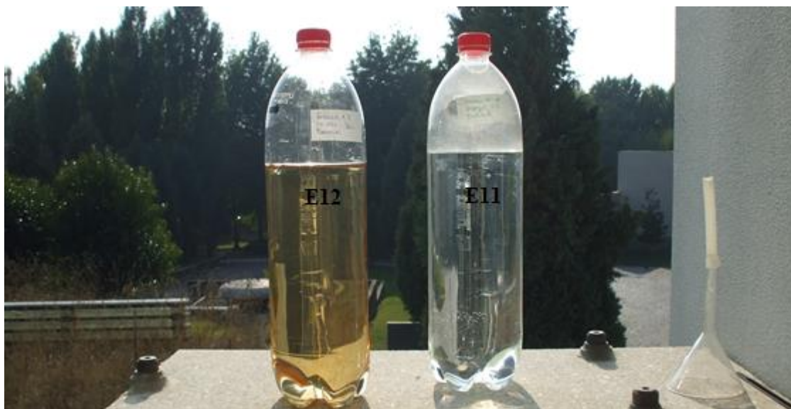
Figura 27 - Aspeto das soluções de [OTC]_0=20 mg/L preparadas com água de abastecimento (E12) e com água destilada (E11).
