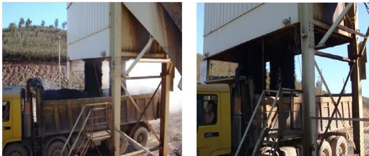
Figura 1 - Diferença nas emissões de fumos e gases observados na central durante a descarga de uma mistura betuminosa a quente e de uma mistura temperada (Ferreira et al., 2009).
