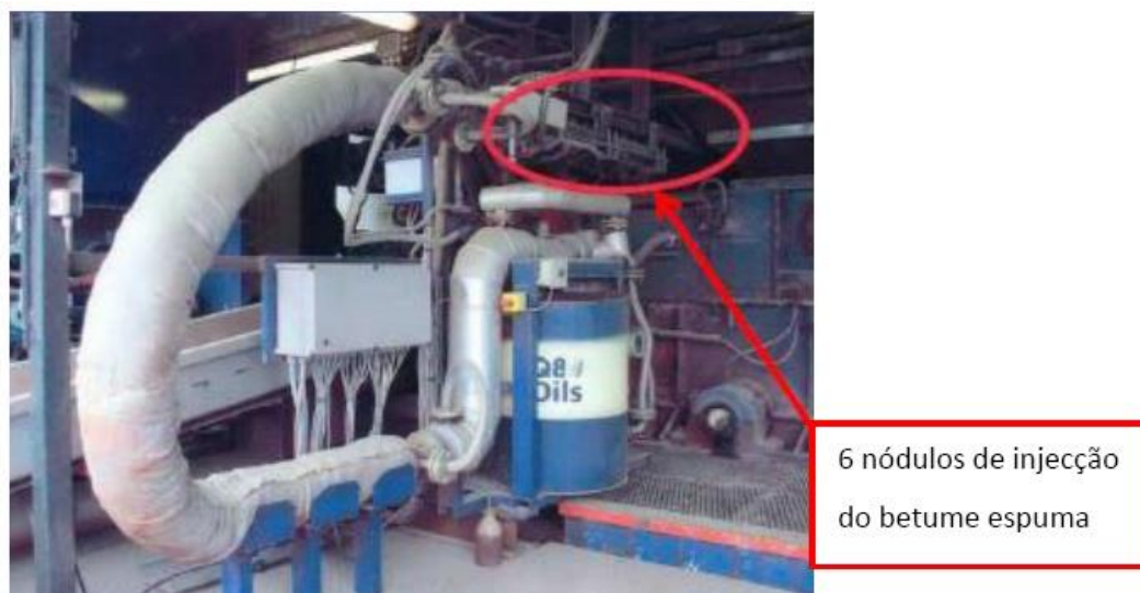
Figura 10 - Injeção do betume-espuma numa central betuminosa (adaptado de D'Angelo et al., 2008 e Pereira, 2010)
