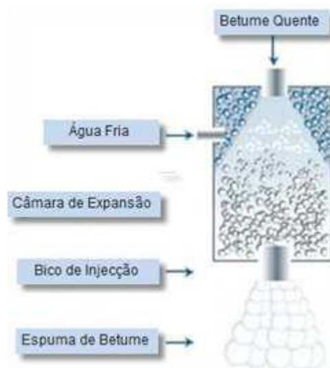
Figura 6 - Unidade de produção de espuma (adaptado de EAPA, 2007 e Ferreira, 2009)
