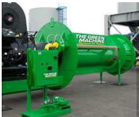
Figura 11 - Dispositivo para execução da espuma de betume da Gencor (adaptado de Gencor, 2009 1 )
