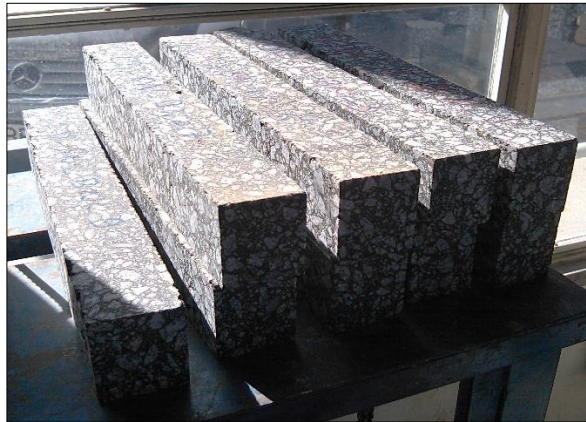
Figura 3.44 - Vigas submetidas a ensaio
