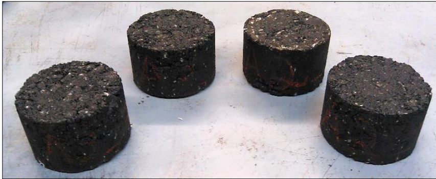
Figura 3.38 – Provetes de mistura convencional submetidos a ensaio de compactabilidade
