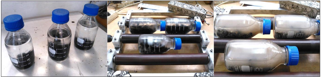
Figura 3.47 – Frascos de ensaio de adesividade e rolamento dos mesmos no início e fim do ensaio
