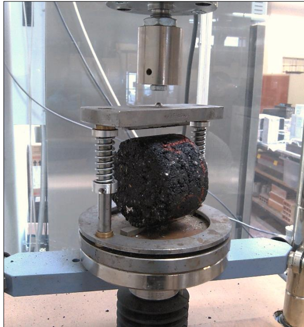
Figura 3.40 – Provete de compactabilidade a ser submetido ao ensaio de resistência à tração indireta
