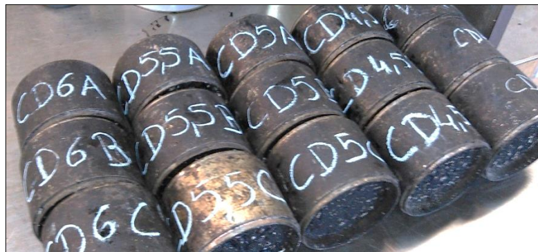
Figura 3.22 – Conjunto de 3 provetes por cada mistura realizada (5 percentagens diferentes de betume)
