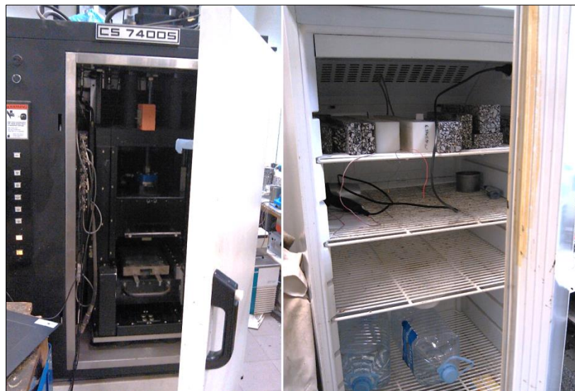
Figura 3.34 – Câmaras de temperatura controlada usadas neste ensaio
