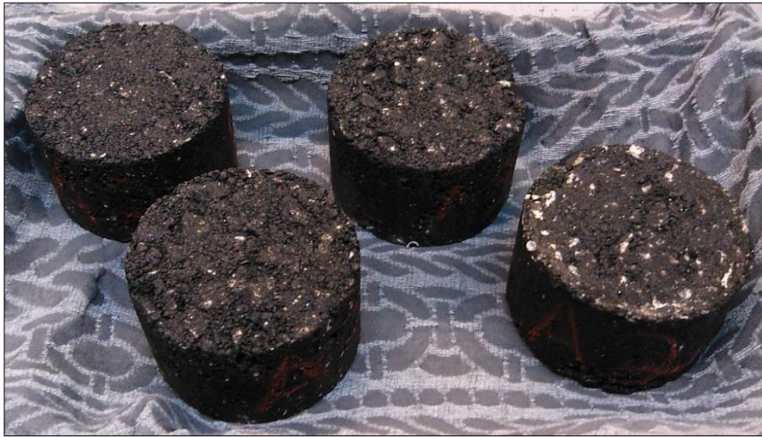
Figura 3.39 – Provetes de betume-espuma submetidos a ensaio de compactabilidade
