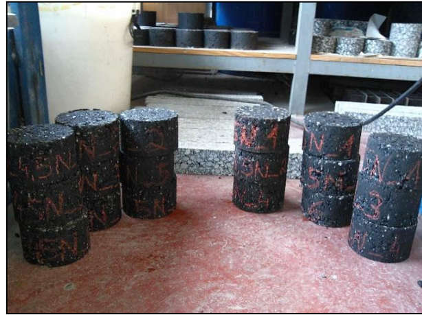
Figura 3.32 – Provetes divididos em conjuntos a serem submetidos à água e ar
