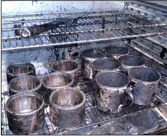
Figura 3.20 – Moldes, recipientes e espátula que servem de auxílio para realização de provetes
