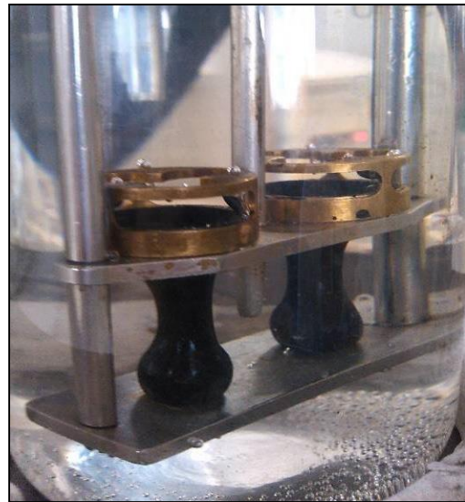
Figura 4.2 – Betume quando atinge temperatura de amolecimento
