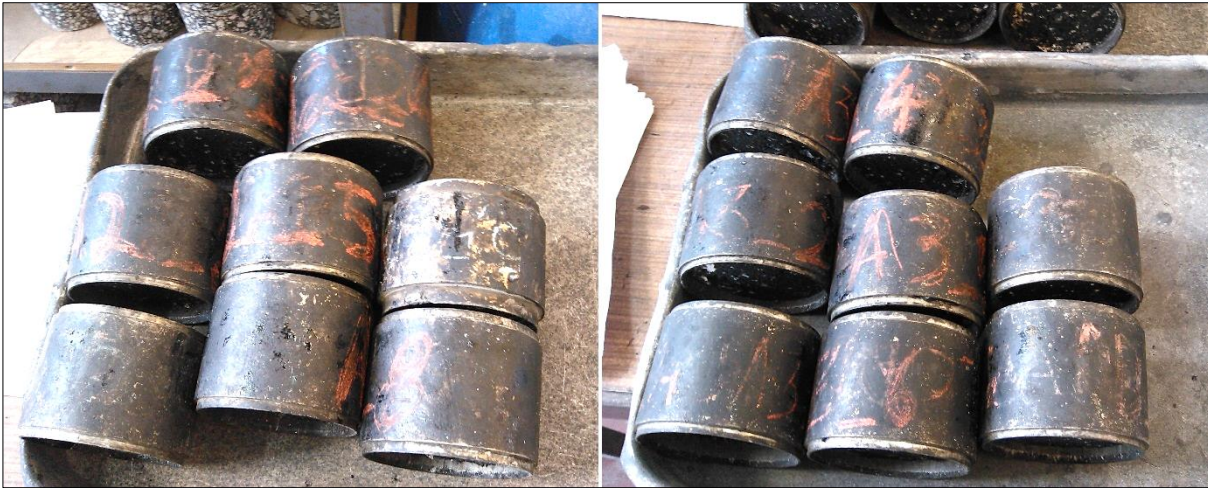
Figura 3.23 – Moldes com mistura betuminosa realizada com betume-espuma
