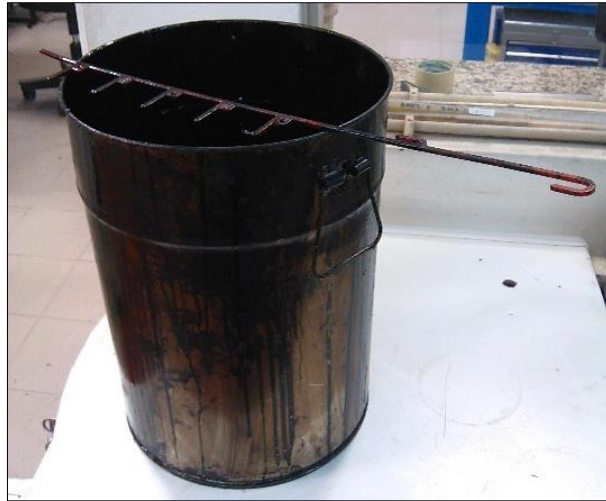
Figura 3.50 – Balde e escala de medição da expansão do betume-espuma
