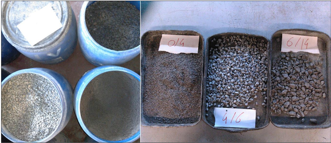
Figura 3.3 – Silos para armazenamento de agregados em laboratório e tabuleiros com amostra
