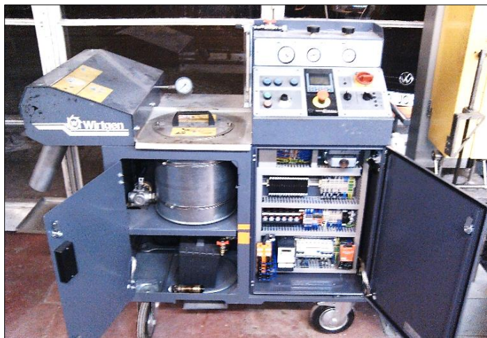
Figura 3.49 – Equipamento que executa a espuma de betume
