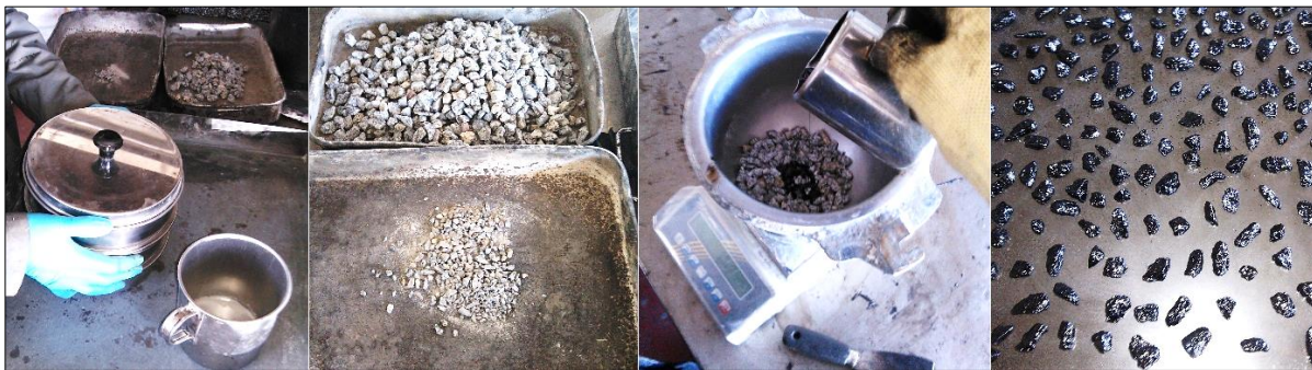
Figura 3.46 – Peneiração dos agregados, realização da mistura e separação das partículas de agregado para submissão a ensaio
