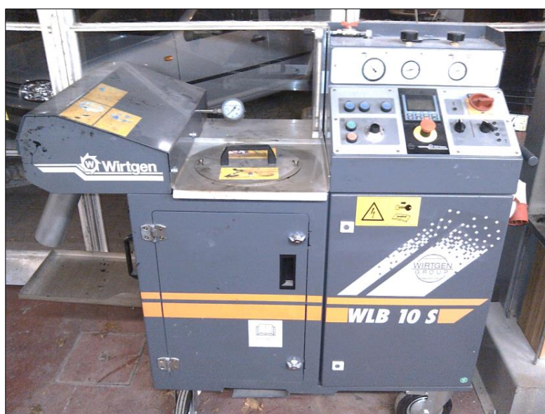
Figura 3.15 – Utilização do equipamento que produz betume-espuma na realização de misturas betuminosas
