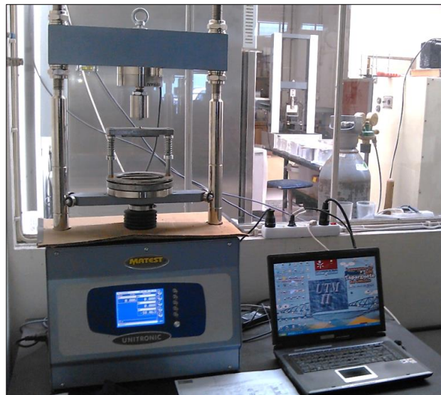
Figura 3.35 – Prensa Marshall, dotada de um sistema de aplicação de carga com bandas de carga, para ensaio à resistência conservada em tração indireta
