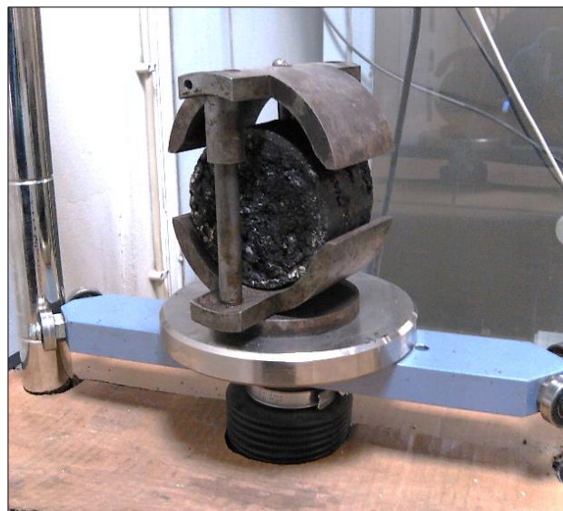
Figura 3.29 - Proвете Marshall preparado a ser ensaiado
