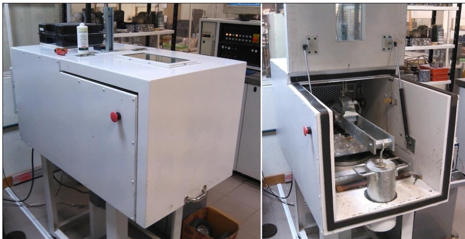
Figura 3.41 – Equipamento que executa o ensaio de pista
