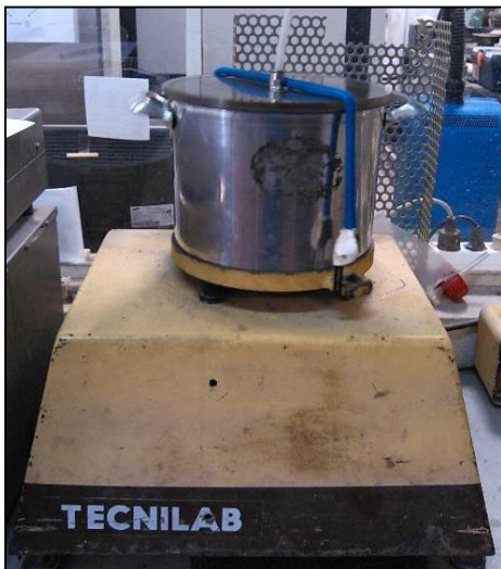
Figura 3.16 – Picnómetro, com mistura betuminosa dentro, na mesa vibratória e submetido a vácuo
