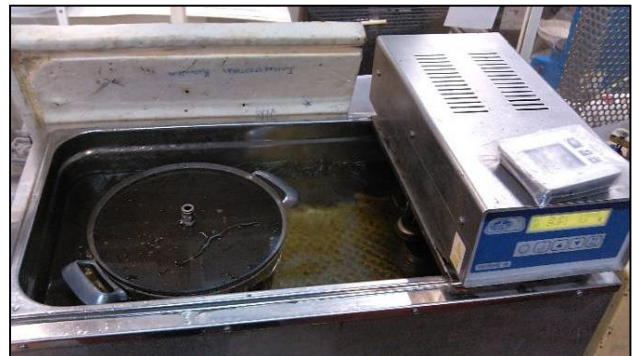
Figura 3.17 – Picnómetro, com mistura betuminosa dentro, em banho de água
