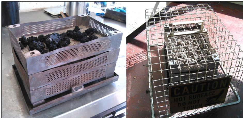
Figura 3.48 – Tabuleiros com a mistura betuminosa antes e depois de ensaio
