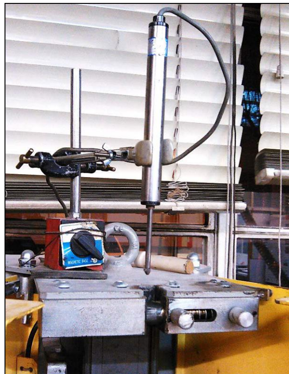
Figura 3.37 – LVDT utilizado para analisar a compactação dos provetes consoante o número de pancadas
