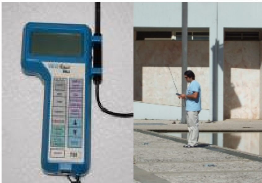
Figura 23- Termo anemómetro e sua utilização
