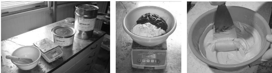
Figura 3.11 - Produção do adesivo epoxídico.
