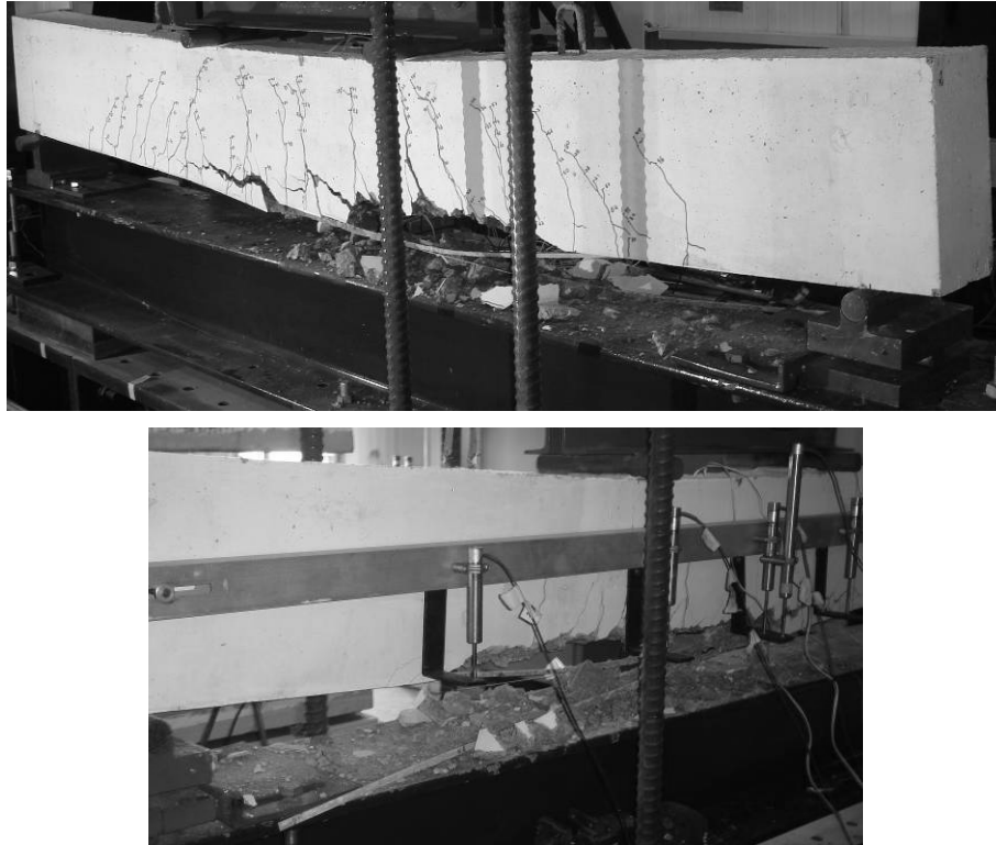
Figura 3.27 - Pormenor do modo de rotura da viga S2-PC2 (destacamento do laminado de CFRP).
