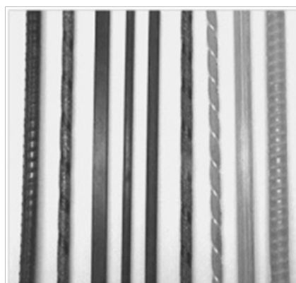
Figura 2.14 - Elementos de CFRP usados no reforço com a técnica NSM (De Lorenzis e Teng, 2007).
