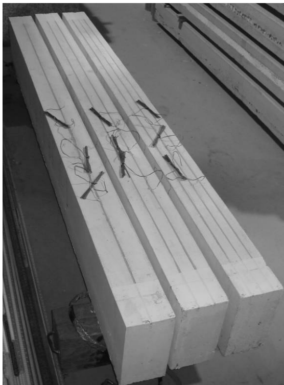
Figura 3.13 - Aspeto final de três vigas reforçadas à flexão com 1, 2 e 3 laminados de CFRP, aplicando a técnica NSM.
