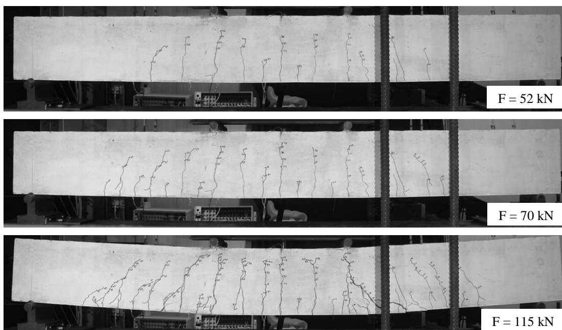
Figura 3.22 - Sequência do ensaio à rotura da viga S2-PC1.
