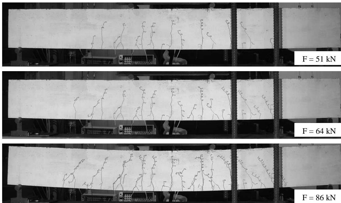
Figura 3.19 - Sequência do ensaio à rotura da viga S1-PC1.
