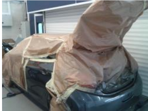
Figura 40 - Viatura com isolamento
