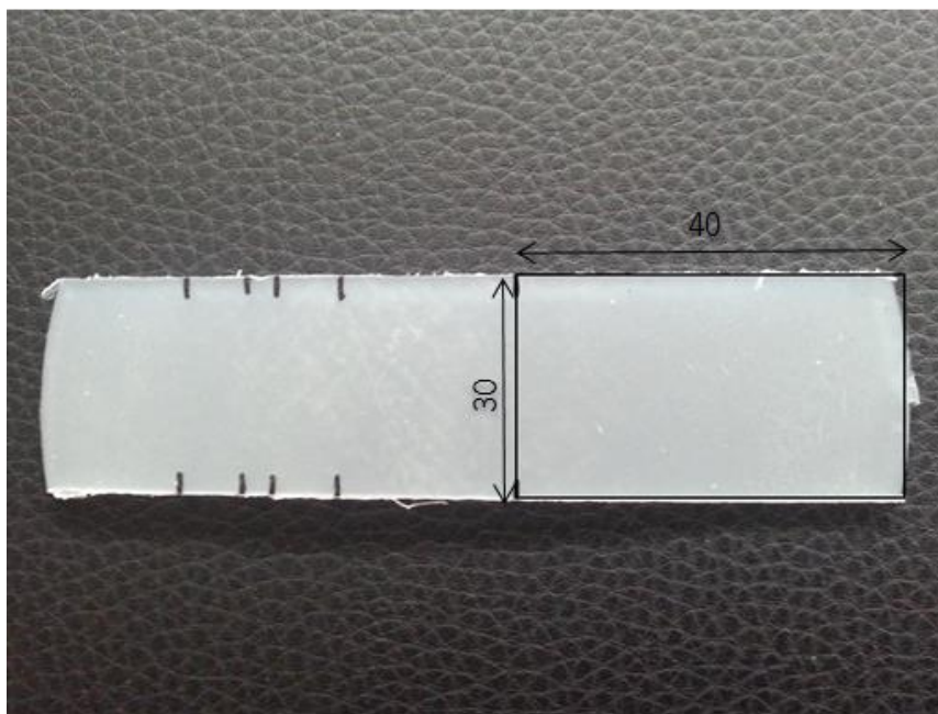
Figura 18 - Zona de corte da amostra para o ensaio de NIR
