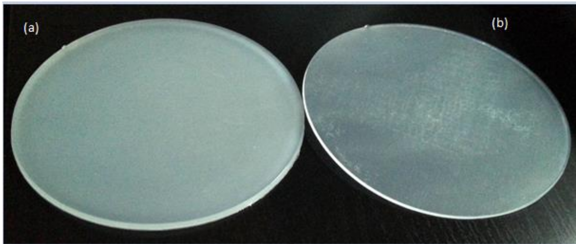
Figura 15 - Discos injetados para o estudo (a) com 3mm de espessura e (b) com 1.5mm de espessura
