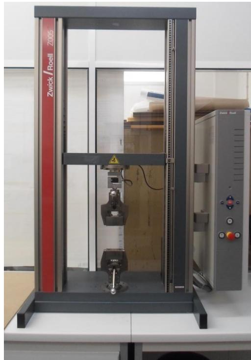
**Figura 42 - Máquina de tração Zwick Roell**
