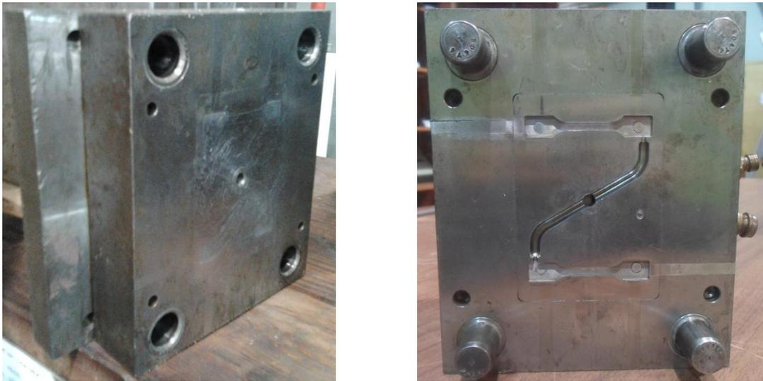
**Figura 22 - Molde utilizado, parte fixa (à esquerda) e parte móvel (à direita).**
