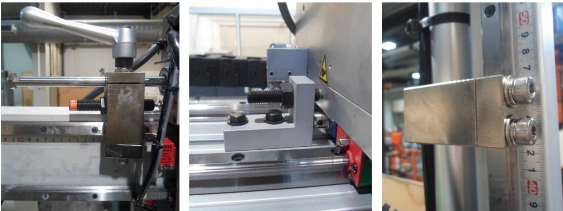
**Figura 25 - Limitadores de movimento, eixo do X (à esquerda), eixo do Y (ao centro) e eixo do Z (à esquerda).**
