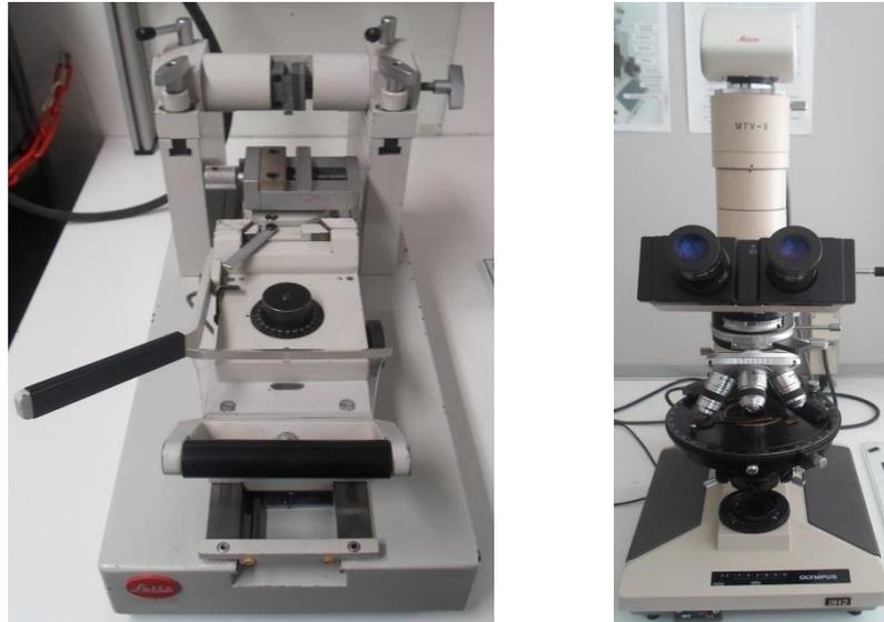
**Figura 41 - Micrótomo Leitz 1401 (à esquerda) e Microscópio de Transmissão Olympus (à direita).**
