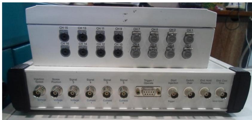
**Figura 34 - Sistema Priamus para leitura dos termopares.**
