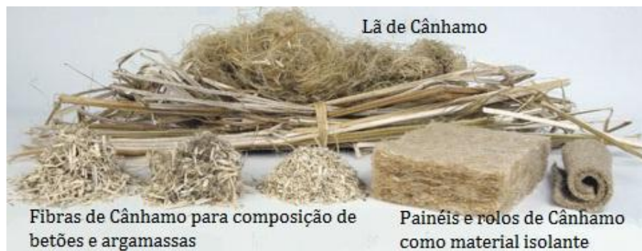
Figura 13: Várias formas e aspetos das fibras de cânhamo na preparação de várias soluções para a construção (Thefreshscents, s/d)
