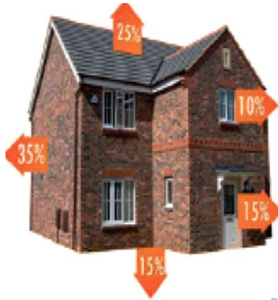
Figura 7: Principais elementos de construção mostrando o percentual de energia que perdem sem alto isolamento. Fonte: Department for Communities and Local Government (DCLG), 2006.
