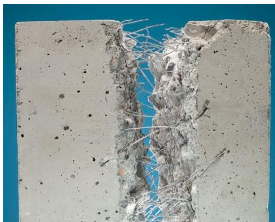
Figura 29 - Betão Reforçado com Fibras de Aço (BRFA)
