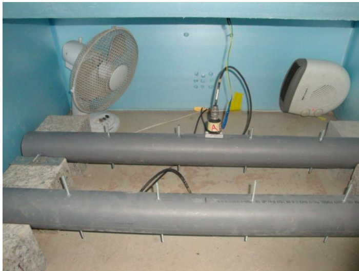
Figura 5.14 - Colocação da ventoinha e termoventilador no interior da camara climática
