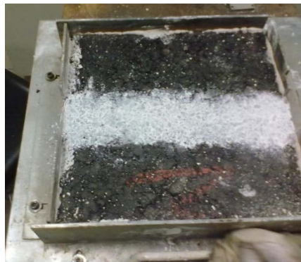
Figura 3.24 – Laje acondicionada e preparada para o ensaio de pista
