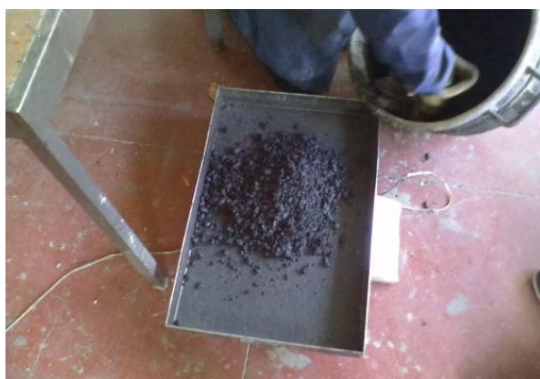
Figura 3.22 – Amostra retirada para determinação da baridade máxima teórica
