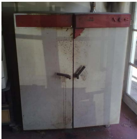
Figura 3.16 – Estufa utilizada para manter os agregados secos e manter os materiais às temperaturas de mistura
