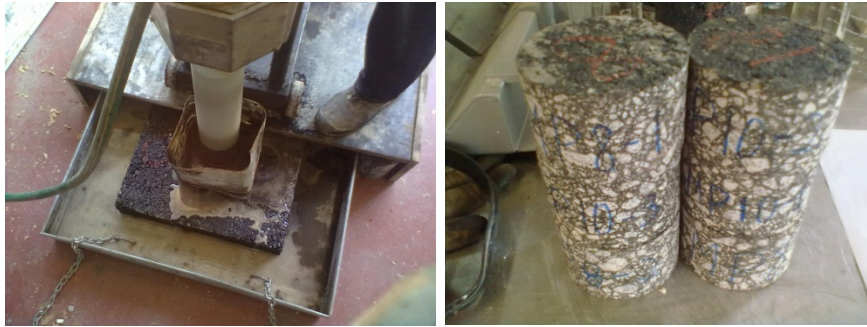
Figura 3.27 – Preparação dos carotes para os ensaios de sensibilidade à água
