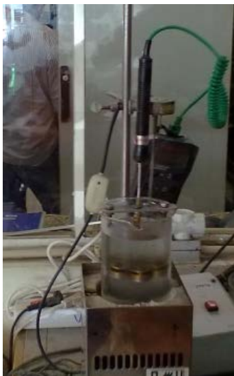
Figura 3.20 – Ensaio de anel e bola realizado no laboratório
