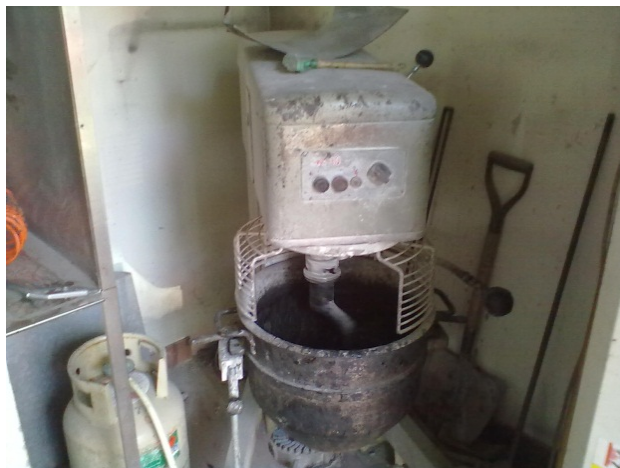
Figura 3.21 – Misturadora com mistura betuminosa
