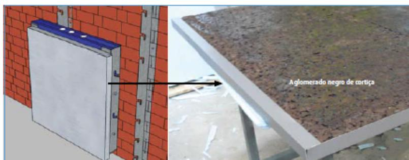
Figura 1 Módulo de reabilitação pré-fabricado.
