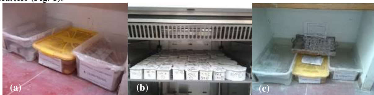
Figura 1: (a) Imersão em solução contendo cloretos; (b) Secagem em câmara de carbonatação; (c) Secagem em ambiente de laboratório
