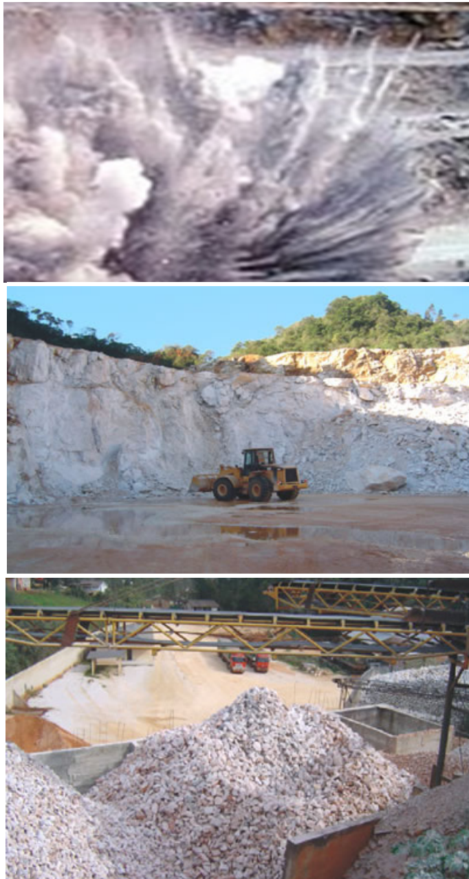
Figura 2.2: Extração de pedra calcária para fabrico da cal
