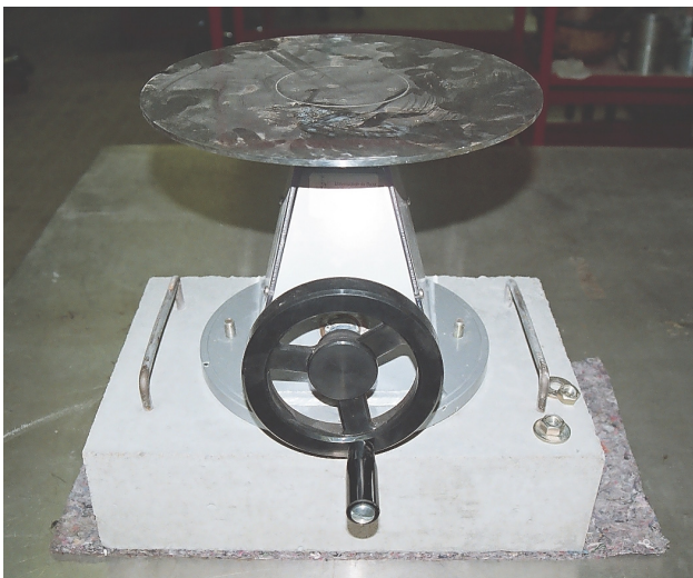
Figura 5.3: Dispositivo para ensaio de espalhamento (EN 1015-3)
