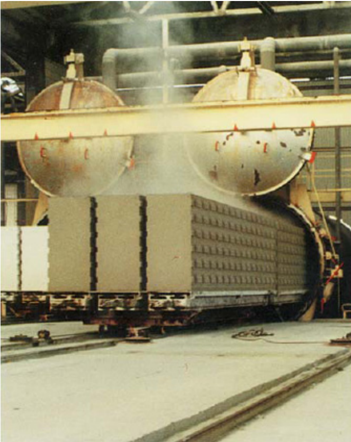
Figura 4.1: Cura de betão celular em autoclave (Guerreiro, 2002)
