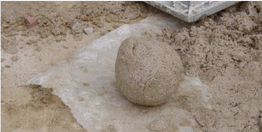
Figura 6.12: Bola de argamassa de consistência seca (Cavaco, 2005)
