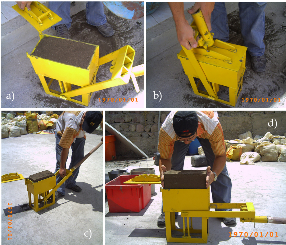
Figura 4.12: Execução de BTC com a prensa Cinva-ram: a) Enchimento da câmara com terra; b) confinamento da mistura; c) elevação do BTC; d) retirada do BTC
