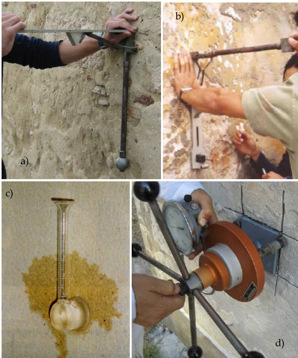
Figura 6.3: Ensaios de caracterização de argamassas “in situ”: a) ensaio de choque de esfera; b) ensaio de penetração controlada; c) ensaio de tubo carsten; d) ensaio de resistência ao arrancamento (Veiga, 2003).
