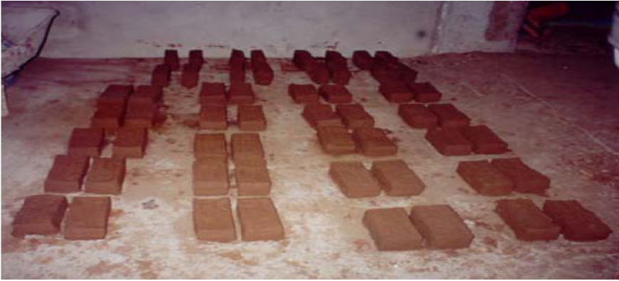
Figura 4.8: Blocos de adobe em fase de cura
