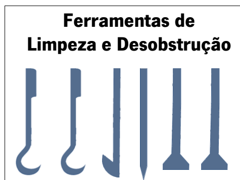
Figura 31 – Quadro de ferramentas para limpeza e desobstrução de máquinas
