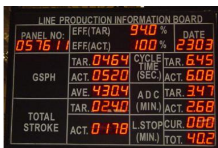
Figura 7 – Exemplo de Andon (retirado de http://realkaizen.com/ )
