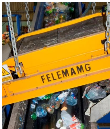
Figura 13 – Separador Magnético (fonte: Resinorte SA)
