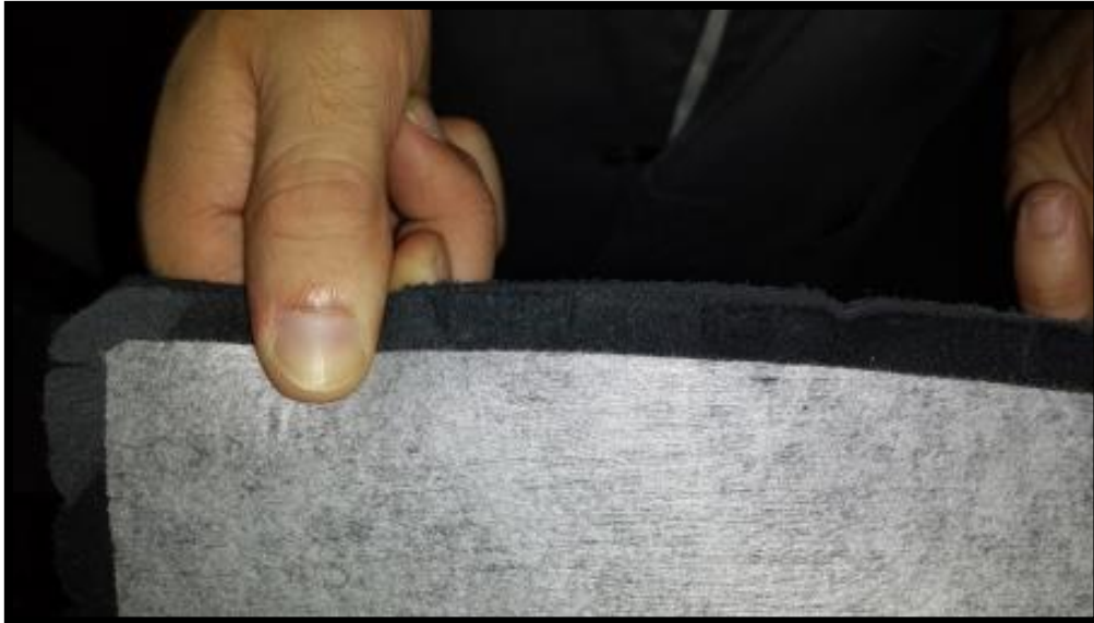
Figura 48 – Demonstração da “abertura” das lâminas que permite a diminuição do esforço na execução da operação em estudo
