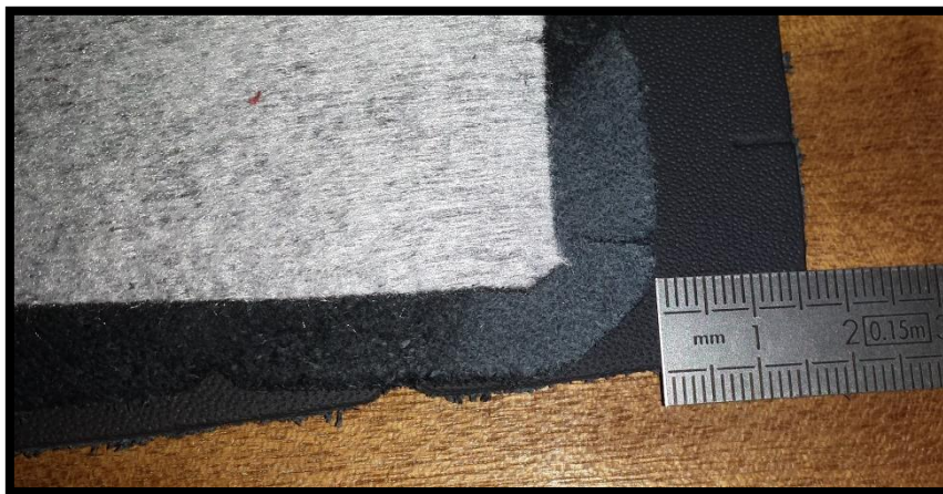
Figura 36 – Diferenças entre duas peças a unir num AT
