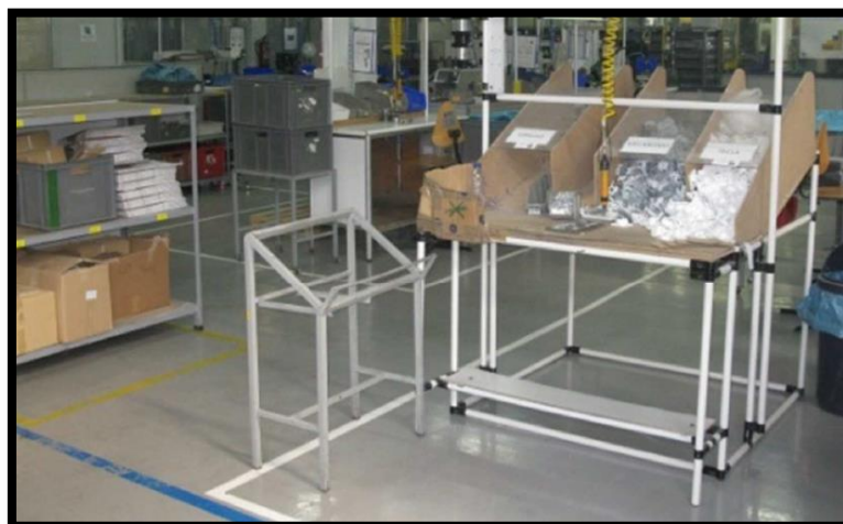
Figura 4 – Exemplo de marcas no chão para delimitar as áreas (adotado de (Loureiro J. , 2012))
