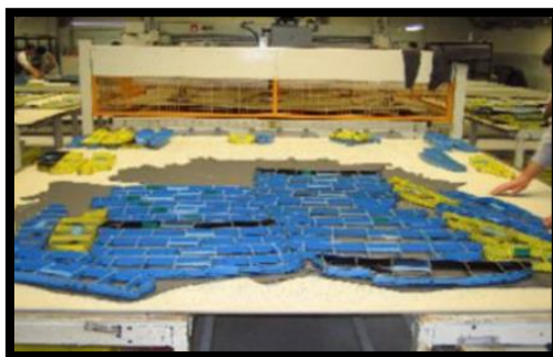
Figura 26 – Cortantes colocados sobre a pele de couro
