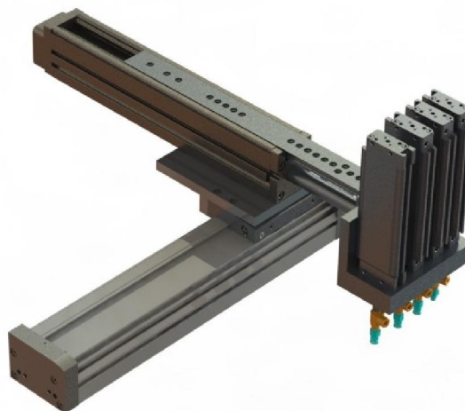
Figura 49 - Sistema tridimensional para a Manipulação das teclas
