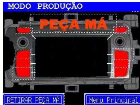
Figura 2 - Ilustração gráfica das teclas em não conformidade
