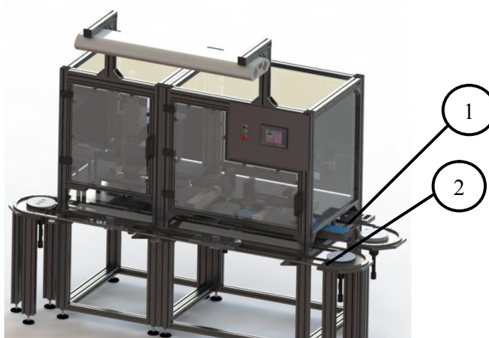
Figura 60 - Conveyor's usados no Dispositivo desenvolvido; 1- Conveyor para o suporte de teclas; 2- Conveyor para o front
