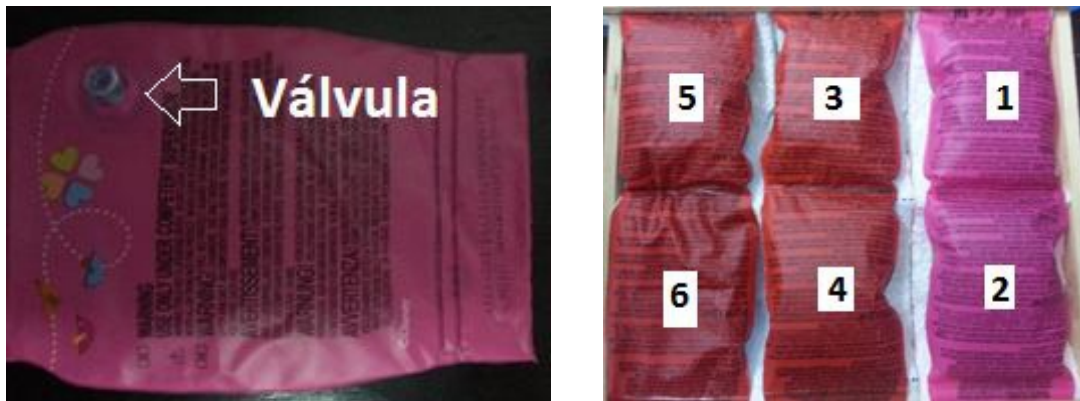
Figura 4.8 - Célula pneumática isolada e conjunto das seis células devidamente posicionadas e numeradas
