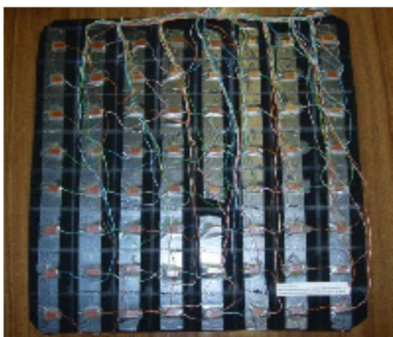
Figura 3.4 - Manta de sensores para almofada com 16 células (Sequeira, 2011)
