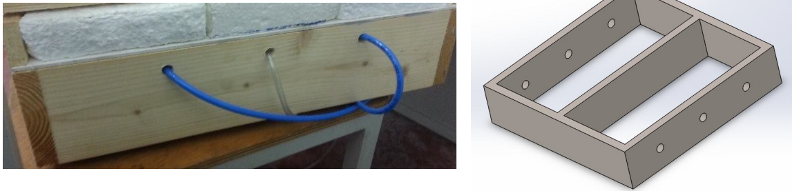
Figura 4.6 – Fotografia da base do protótipo criada e modelo tridimensional
