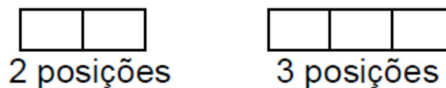
Figura 2.23 - Quantidade de posições de uma válvula (Instituto Federal do Espírito Santo, s.d.)
