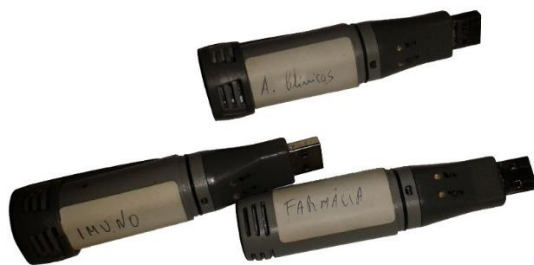
Figura 4.6 . Data loggers de medição de temperatura(esquerda) e “Lay out” de apresentação do software Easy Log Usb(direita)
