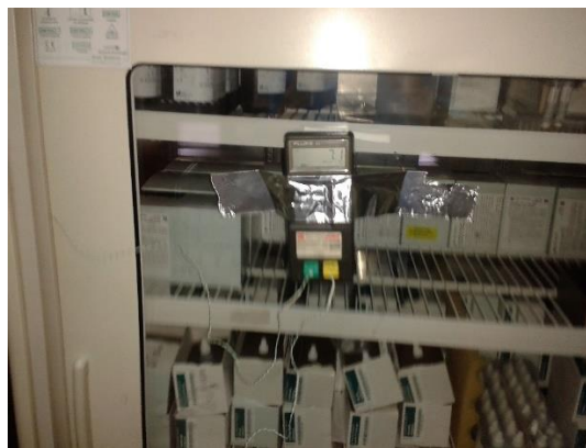
Figura 4.3 – Colocação do multimetros suspenso e fixo para registo de dados
