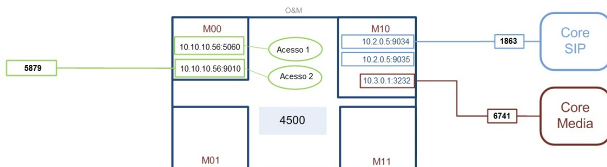
Figura 4.9: Arquitetura de rede de equipamento SBC
