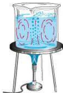
Figura 20: Exemplo das correntes de convecção no aquecimento de água
