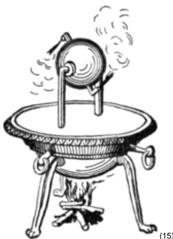
Figura 35: Considerada a primeira máquina térmica, construída por Heron de Alexandria, era constituída por uma esfera de cobre com duas aberturas por onde se expelia o vapor de água formado a partir do aquecimento de água num reservatório
