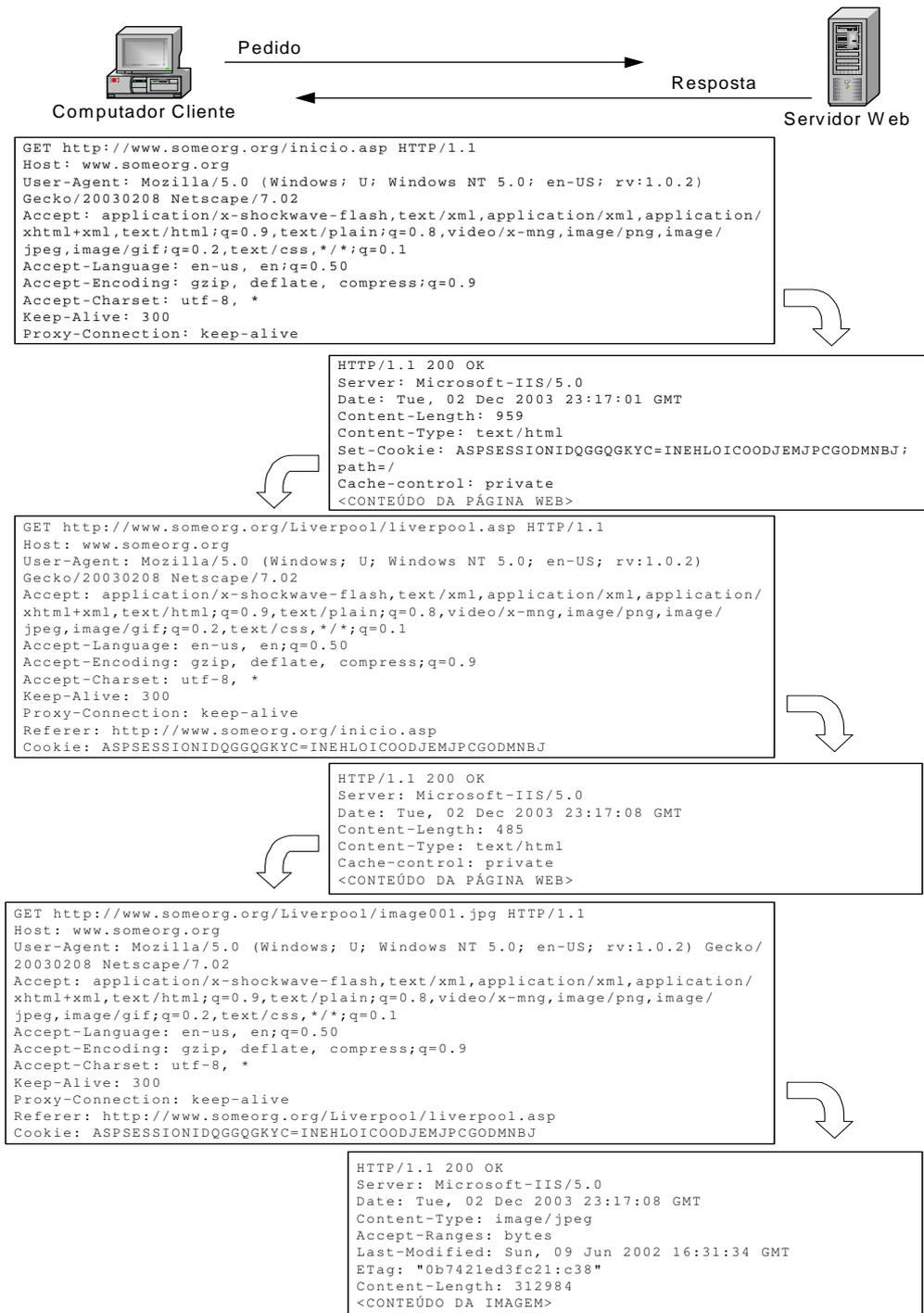
Figura 2.2 - Comunicação HTTP entre cliente e servidor *Web*
