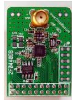
**Figura 11: nRF9E5 Sub-1GHz da Nordic™ [11].**
