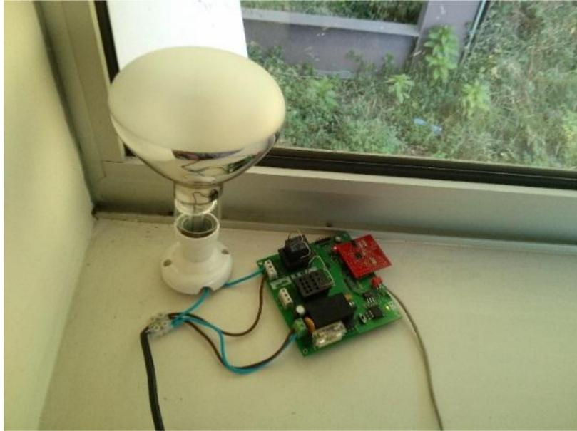
**Figura 61: *Zone Climate Control* a simular a ligação ao ventiloconvector com lâmpada de alto consumo.**
