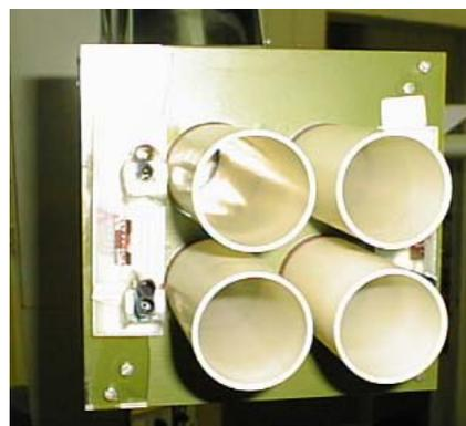
Figura V.3 Vista lateral e frontal dos ultrassons e infravermelhos que foram montados no punho do robô.
