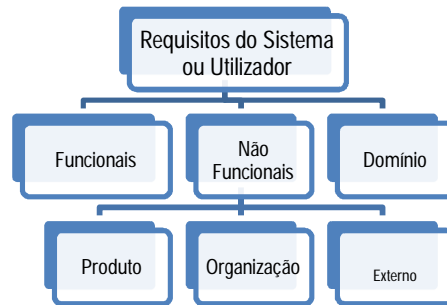
Figura 18 Estrutura dos Requisitos (Puntel, 2013).
