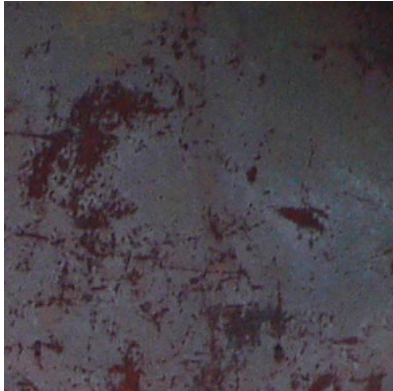
Evolução da oxidação do aço corten.
