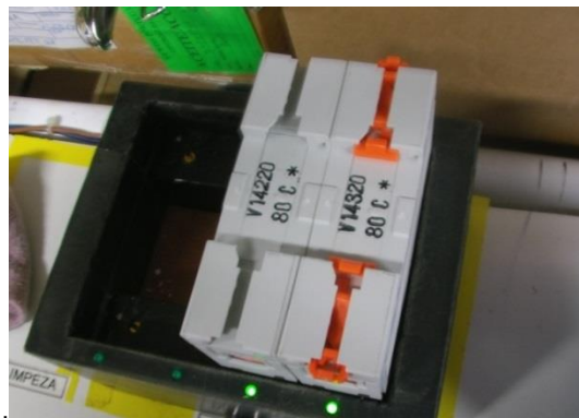
Figura 57 – Novo dispositivo de teste de continuidade
