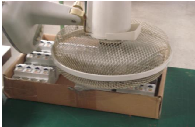
Figura 47 – Ventoinha de arrefecimento dos polos MT-HP
