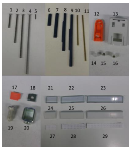
Figura 22 - Componentes montados na linha MT-HP
