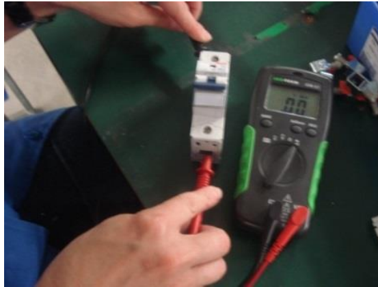
Figura 48 – Teste de continuidade usando um multímetro
