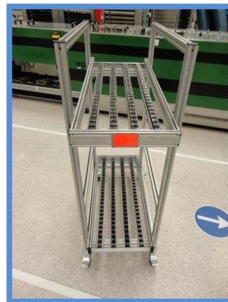
Figura 7.65 – Exemplo de rampa que abastece o V-Cut+Laquer
