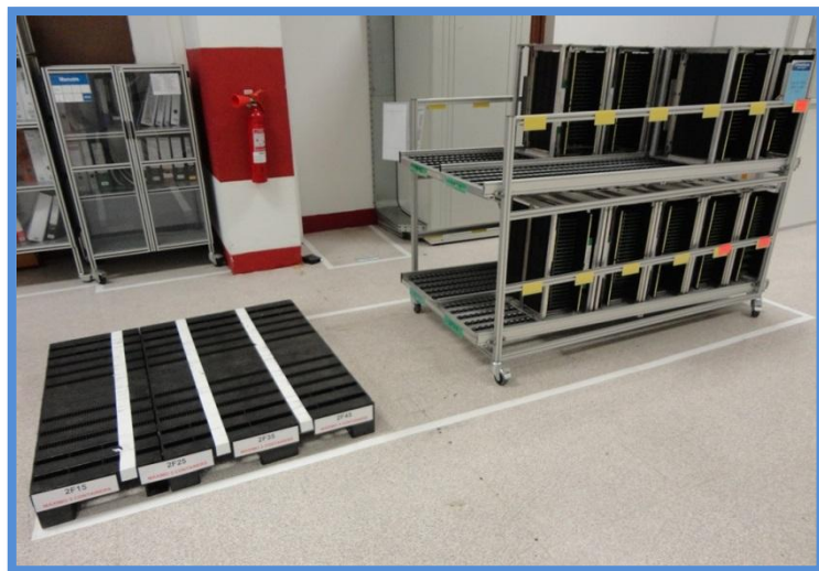
Figura 7.62 – Stock entre a pré-montagem e a montagem final
