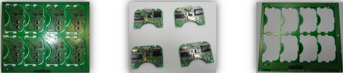
Figura 4.8 – Placa nutzen (à esquerda), PCB's (ao centro) e sucata da placa depois de fresada (à direita)
