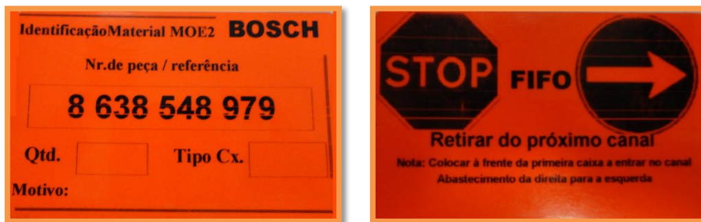
Figura 4.17 - Cartão de identificação de material (à esquerda) e cartão FIFO (à direita)
