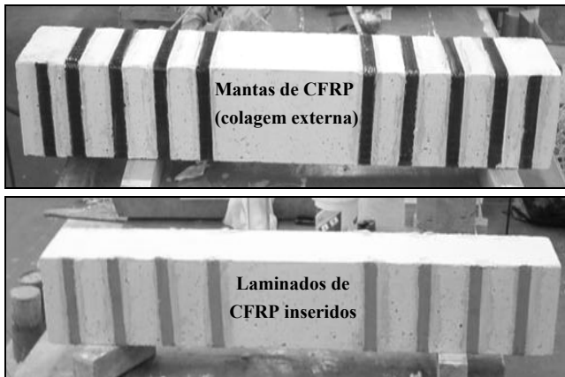
Figura 3 – Sistema curado “in situ” e sistema pré-fabricado (aplicação do reforço)
