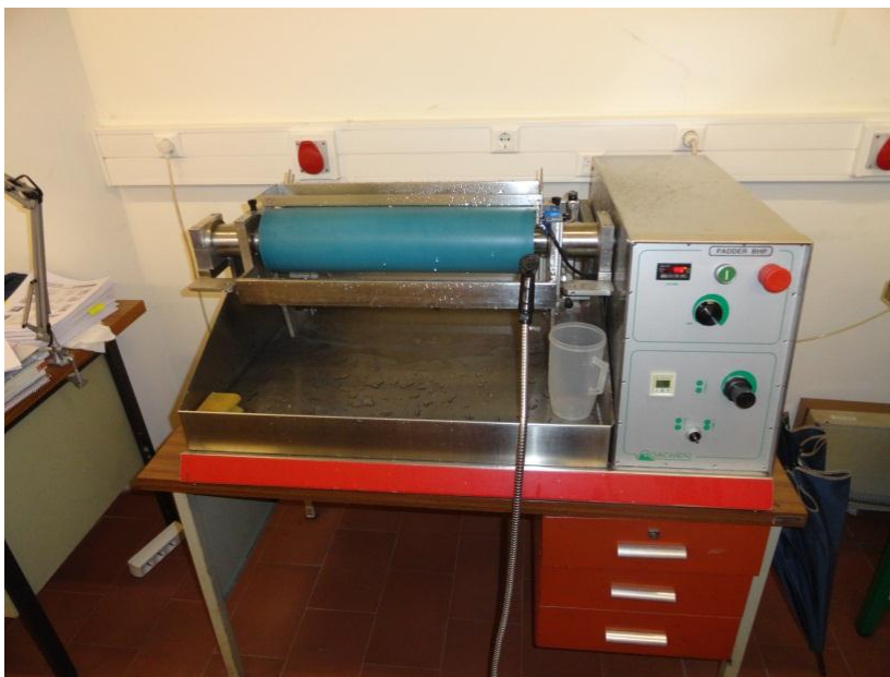
Fig.42- Foulard empregado para aplicar os PCM 's. (fonte: própria autora).
