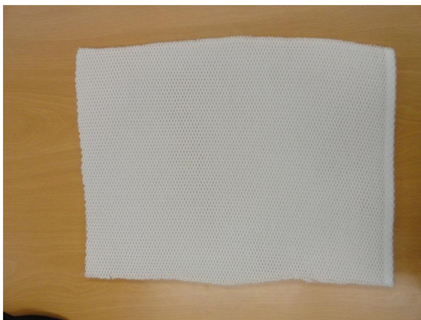
Fig. 40- Têxtil base, Spacer de fibra de poliéster. (fonte: própria autora)
