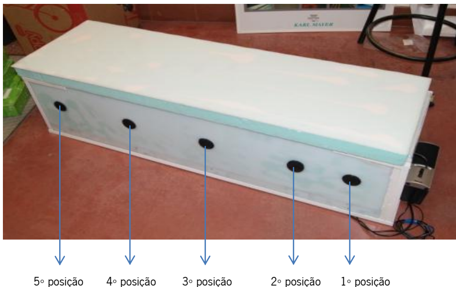
Fig. 50 - Caixa para realizar o teste de atenuação acústica e marcação das posições. (fonte: foto realizada por André Alves)
