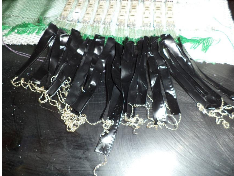
Fig.48 - Fios condutores protegidos com fita isolante. (fonte: própria autora)
