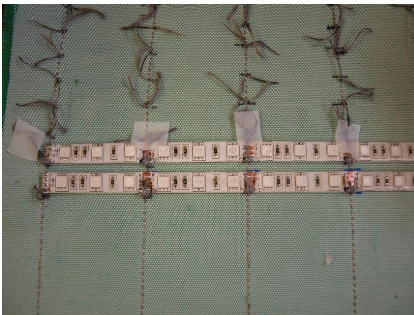
Fig.30 - LEDs agregados ao Têxtil com auxílio de cola condutora. (fonte: própria autora)
