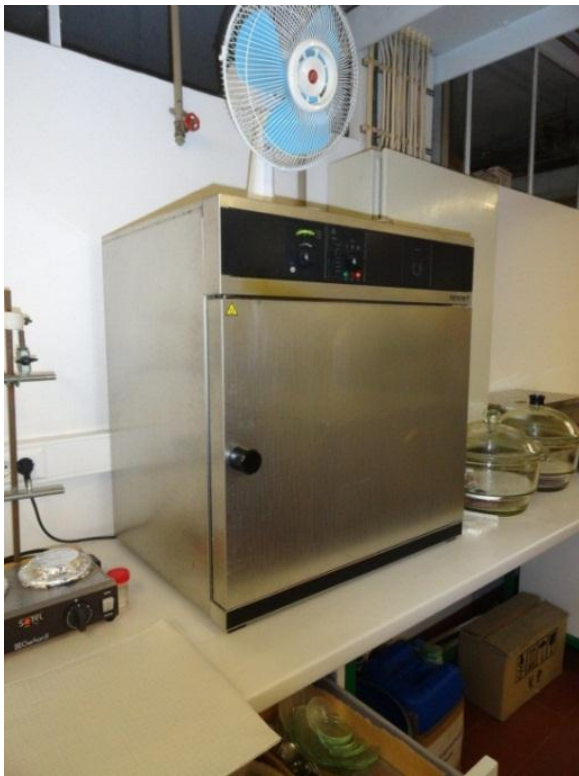
Fig.44 - Estufa utilizada para fixar os PCM 's ao Spacer . (fonte: própria autora)
