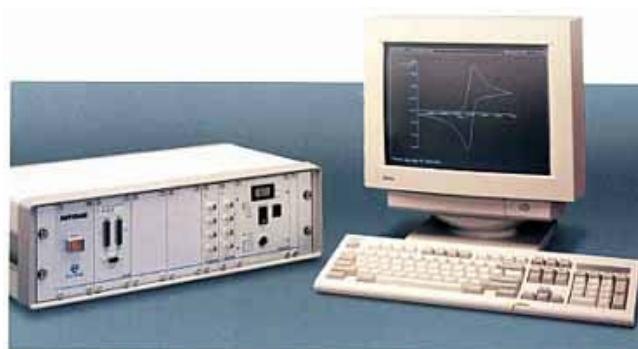
Figura 2.4 – Potenciostato/Galvanostato Autolab acoplado a um computador similar ao utilizado no decorrer do trabalho.
