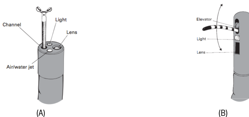
Fig. C.2 - (A) Câmara com visão “ direct forward ”, (B) Câmara com visão lateral (retirado de [38])
