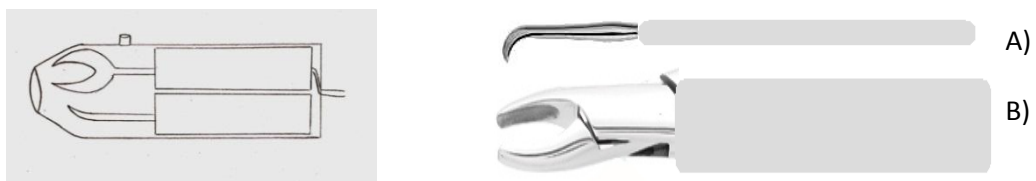
Figura 7.4 - Desenho representativo da solução cujo princípio é a caneta multicolor. A) e B) recargas interiores da caneta
