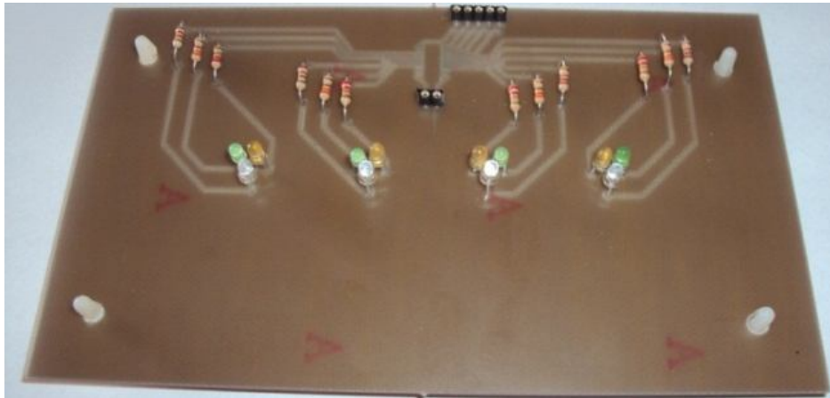
Figura 5.21 PCB com sistema de iluminação (LEDs, resistências e multiplexer ).
