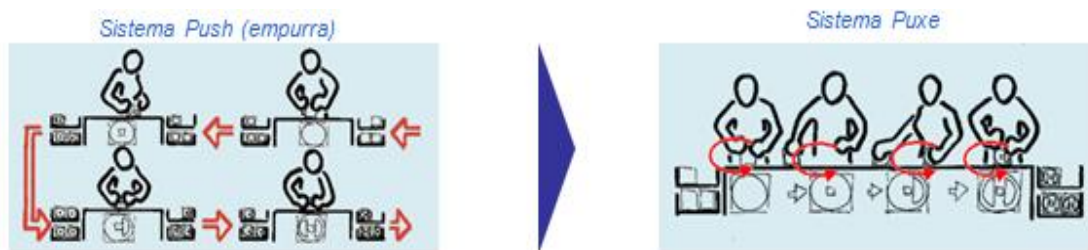
Figura 21 - As diferenças entre o sistema Push e o sistema de Puxar ( Pull ) (BOSCH, 2009).
