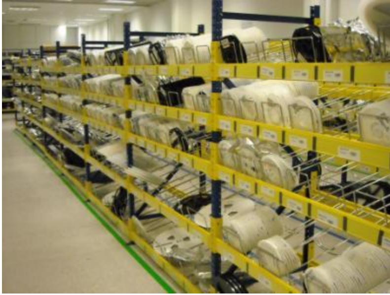
Figura 36 – Estantes de bobines do supermercado de SMD's. (BOSCH, 2009).
