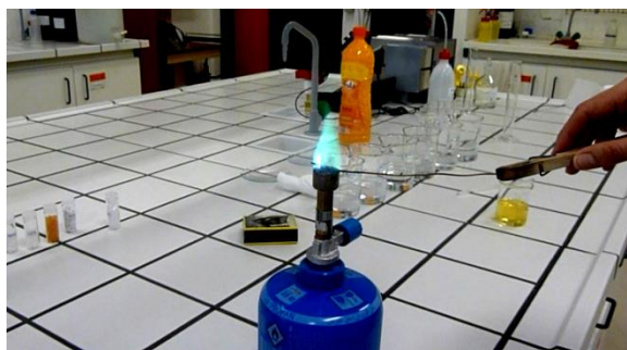
Figura 4.2. - Chama verde obtida a partir do isolante do fio de cobre
