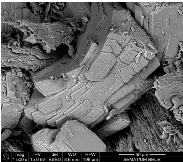
Fig. 1 Imagem em modo BSED correspondente à fase não identificada 'UK.FOLG.1'.
