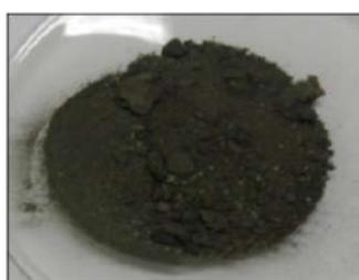
Fig.1\_Cimento obtido por recirculação da solução em sucata de ferro.
