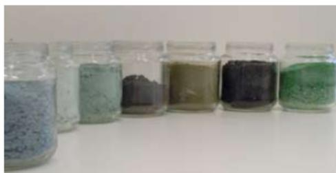
Fig.4\_Lamas galvânicas e produtos obtidos ao longo do processo.
