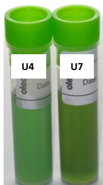
Figura 12 Fotografia de duas amostras representativas do nível 4 do OleoTest® (entre 17% e 21%). Amostra U4 foi obtida através de um processo de fritura descontínua enquanto a amostra U7 foi obtida através de um processo de fritura contínua.
