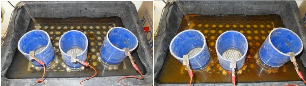
Figura 8. Ensaio de migração de cloretos de BRFA em curso, após 6 horas (esquerda) e 24 horas (direita).
