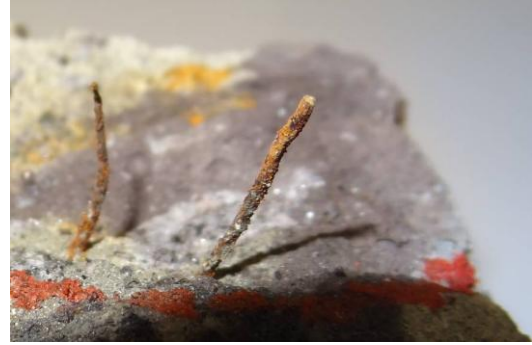
Figura 11. Corrosão das fibras de aço do BRFA após 72 horas de ensaio de migração de cloretos.
