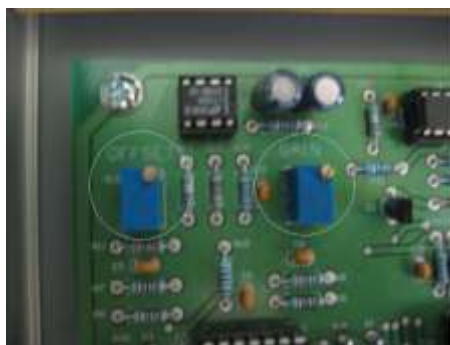
Figura 31 - Circuito electrónico do transdutor de força, em evidência os potenciômetros de ajuste do offset e do ganho do sistema.
