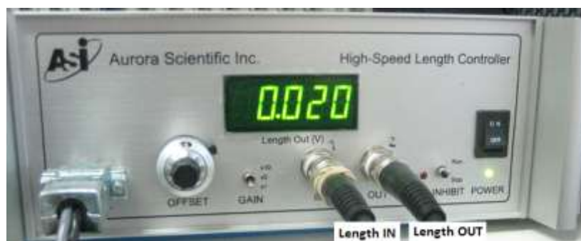
Figura 27 - Painel frontal da caixa eletrónica do controlador de comprimento de alta velocidade.
