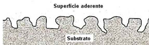
Figura 21. Mechanical Interlocking entre a superfície aderente e o substrato (Van Noort, 2007).
