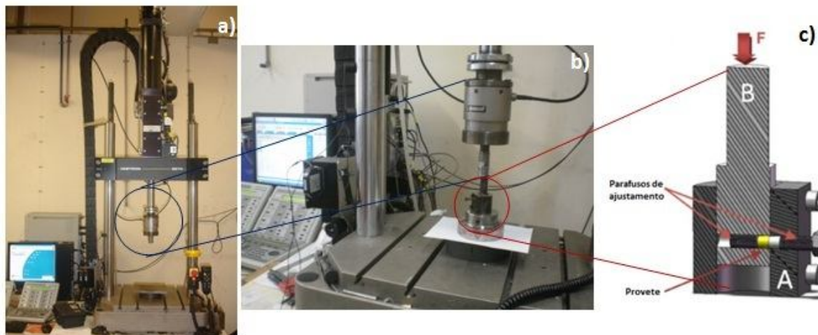
Figura 42. Máquina de testes universal (a); Pormenor da célula de carga da máquina de testes universal a pressionar o dispositivo de teste de corte (b); Esquema em corte do dispositivo de teste de corte (c) [adaptado de ((Henriques & al, 2011a)].
