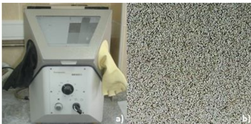
Figura 38. Dispositivo das instalações da Dental Castro na qual foi realizada a granalhagem (a) e aspecto global da superfície do metal após granalhagem (ampliação 200X) [adaptado de (Beer, Johnston, & Dewolf, 2003)].
