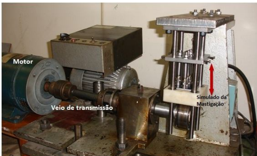
Figura 33. Dispositivo utilizado para realizar os testes de fadiga mecânica, CT2M, Azurém, Portugal.
