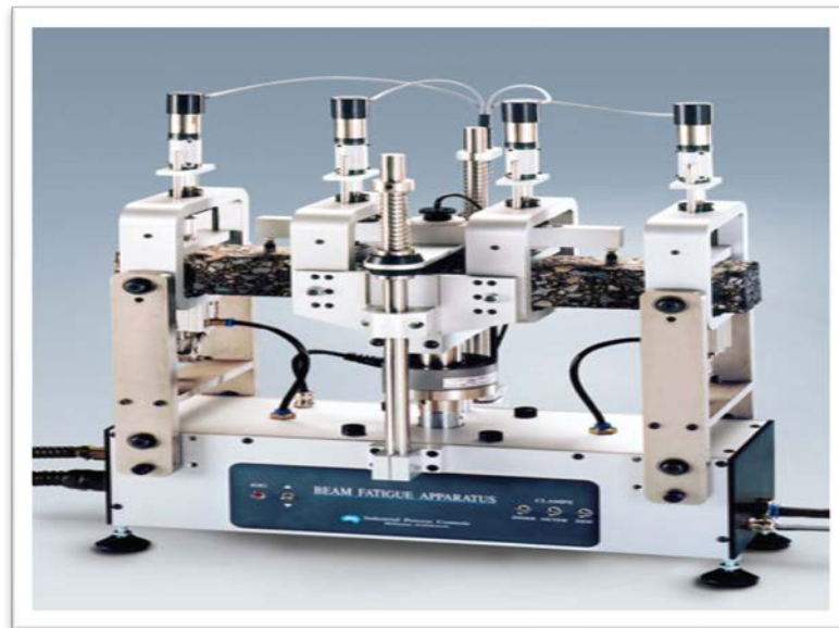
Figura 2-24 – Máquina para ensaio de vida de fadiga para concretos asfálticos utilizando corpos de prova em formato de viga
