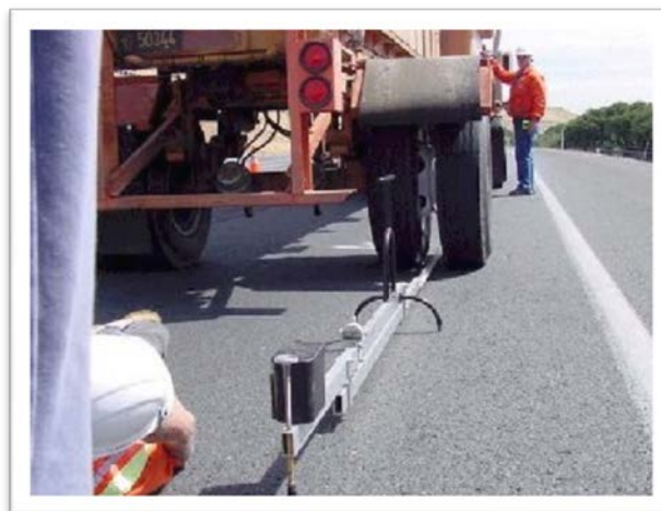
Figura 3-17 – A Viga Benkelman é utilizada para medir as deformações do pavimento quando é aplicada uma carga conhecida (caminhão)
