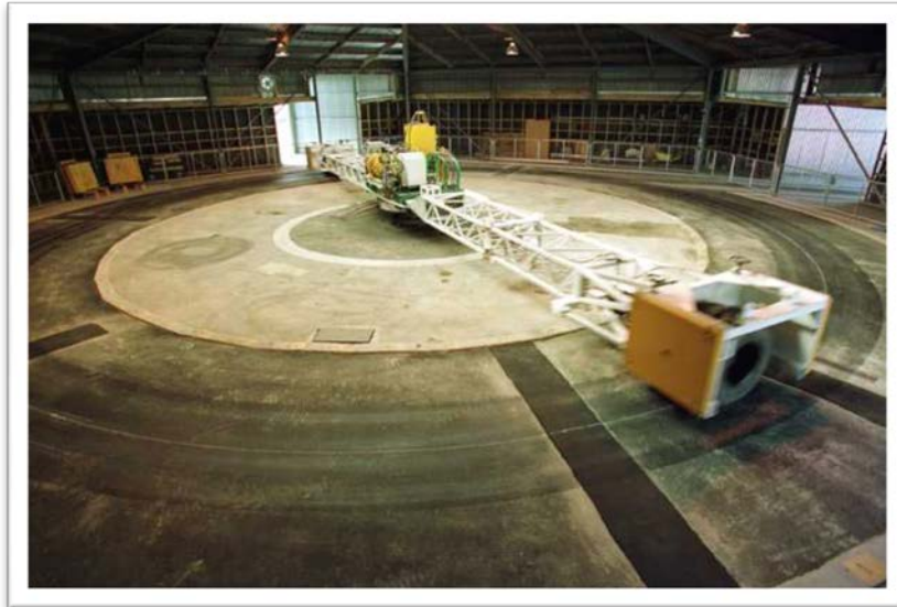
Figura 2-26 – Simulador de tráfego circular da Canterbury Accelerated Pavement Testing Indoor Facility (Nova Zelândia)
