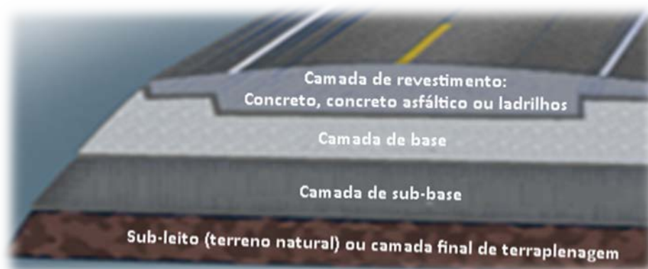
Figura 2-1 – Estrutura típica dos pavimentos
