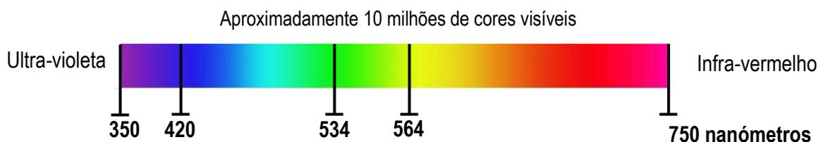
**Figura 1. 12 - Espectro de Comprimento de Onda [46]**
